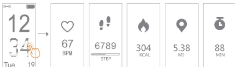
Kliknutím přepnete mezi tepovou frekvencí, počtem kroků, kalorií, vzdáleností, dobou cvičení
